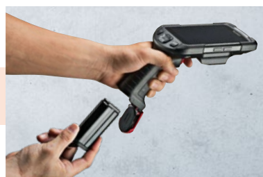
Austauschen des Hauptakkus, während das Gerät noch eingeschaltet ist
